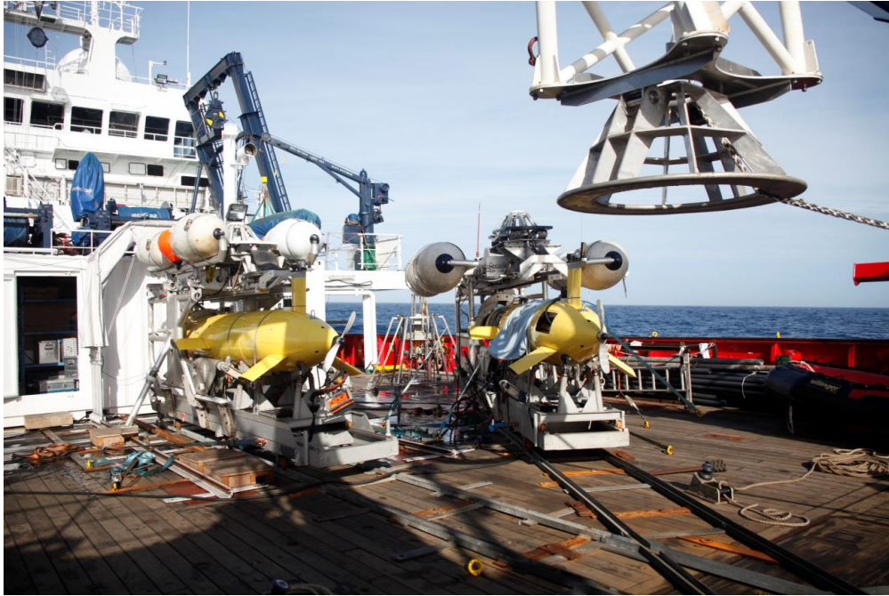
Els AUV AsterX i IdefX, amb els seus sistemes de llançament respectius (Caliste) a la coberta del “Sarmiento de Gamboa”. En alta resolució a:
