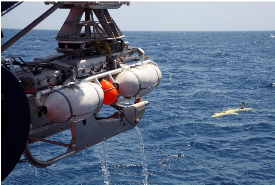
En primer pla, la plataforma de llançament Caliste, un cop ha deixat l'AUV AsterX a l'aigua (en segon pla), a punt per començar la immersió. En alta resolució a:
